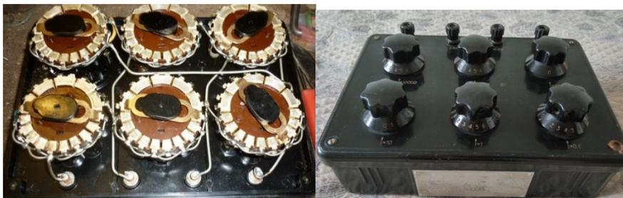
Рис.1 – Магазин сопротивлений без верхней панели (слева) и в рабочем состоянии (справа)
