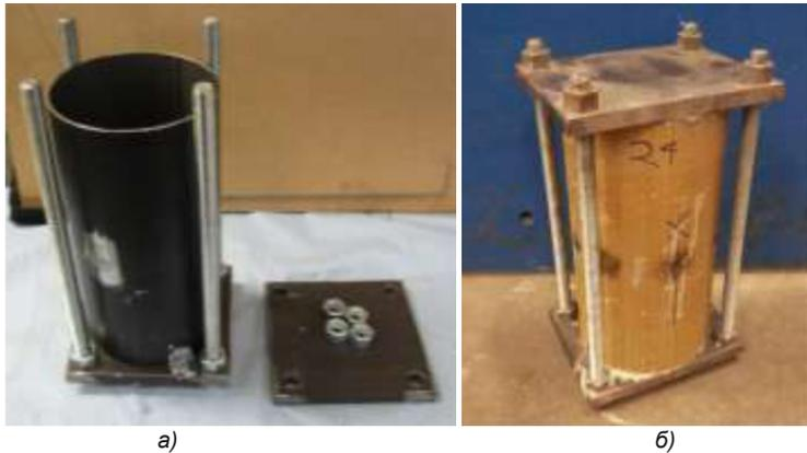
Рисунок 1. Стальные торцевые колпачки и стержень, используемые для восстановления преднапряжения: а) образец стальной трубы перед отливкой контрольного образца; б) образец ЗБПТ во время отверждения бетона
